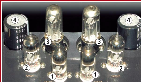
Vue étage de sortie à tubes. Etage de sortie audio analogique à tubes (configuration double mono). 1 - Double triodes (une par canal) 12AX7 (équivalent ECC83) utilisées en préamplification. 2 - Double triodes 12AU7 (équivalent ECC82) pour l'adaptation d'impédance. 3 - Valves redresseuses 5AR4. 4 - filtrage d'alimentations par deux condensateurs de 470 µF / 450 V.
