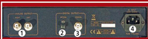
1 - Sortie analogique asymétrique sur prise Cinch à contact doré. 2 - Sortie numérique optique Toslink pour utilisation d'un convertisseur extérieur. 3 - Sortie numérique coaxiale Cinch SPDIF. 4 - Embase de raccordement pour le cordon secteur.
